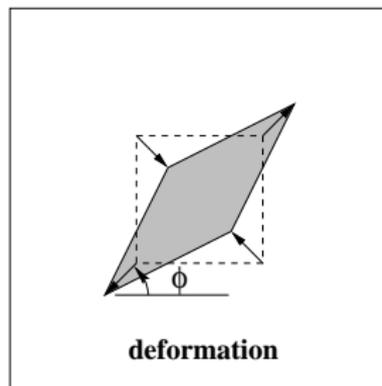
Abbildung: Dekomposition der planaren affinen Transformation in eine Rotation und Deformation (anisotrope Skalierung in orthogonale Skalierungsrichtungen)
