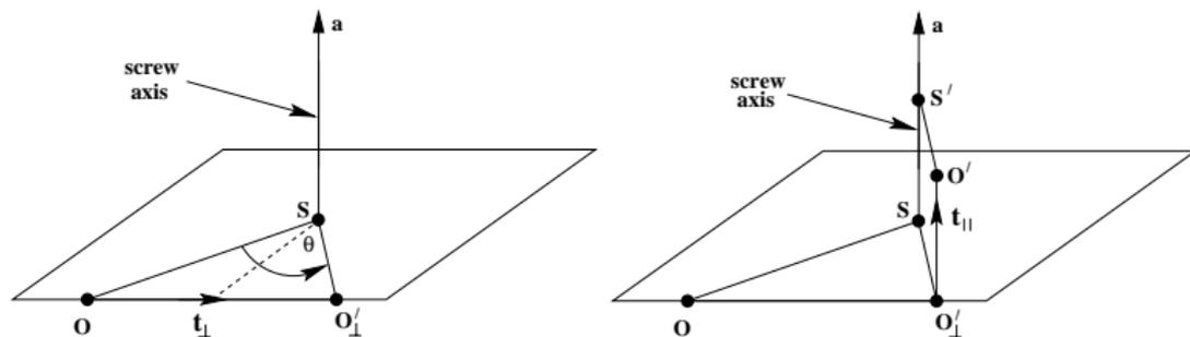
Abbildung: 3d-Euklidische Bewegung und Schraubendekomposition
