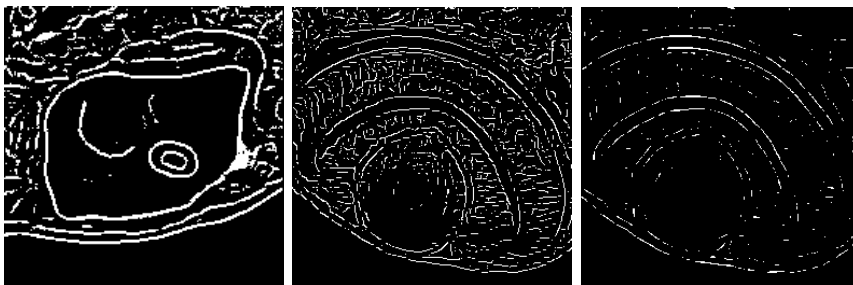
Abbildung 5.3: Links und mitte: Mit erlaubter Fehlerzahl acht wirken die Strukturen übersättigt, Flächen werden teils mehrfach detektiert, es werden zu viele Interest Points gefunden. Rechts: Wird die erlaubte Fehlerzahl auf eins gesenkt, genügen nur noch wenige Punkte der Filterbedingung.
