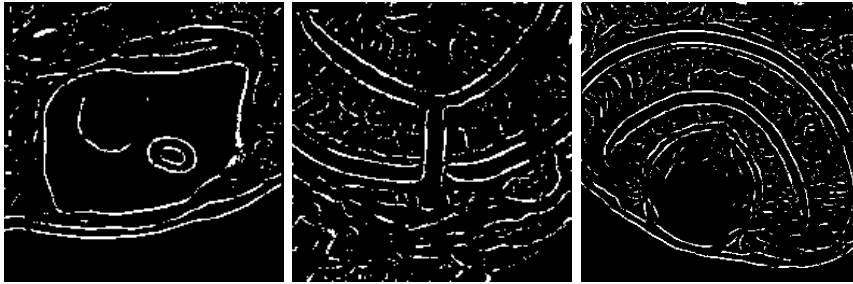
Abbildung 5.2: Bei Erhöhung der erlaubten Fehler auf vier (Schrittweite zwei) werden Strukturen stärker, es treten aber auch Doppeldetektionen von stark ausgeprägten Flächen wie der Augenränder auf.
