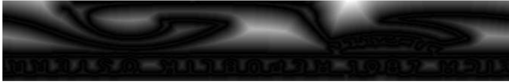
Abbildung 16: Euklid'sche Distance Transform zu dem Beispiel aus Abbildung 6.
